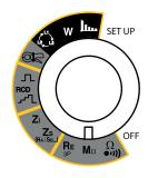
Mit den Messleitungen verbinden Sie das Testobjekt mit den Buchsen COM und  $M\Omega$  des Geräts. Das Testobjekt darf nicht unter Spannung stehen.
